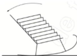
b) Método para mecedoras: Movimiento de ensayo
